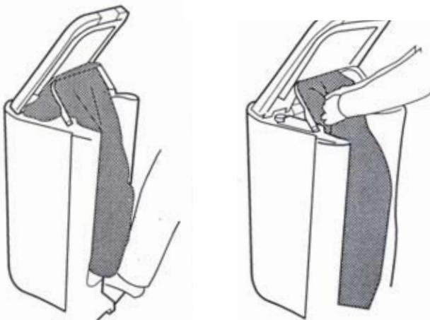
Levantar la pletina de sujeción de la bolsa hacia la posición vertical y automáticamente queda liberada. Sacar la bolsa.
