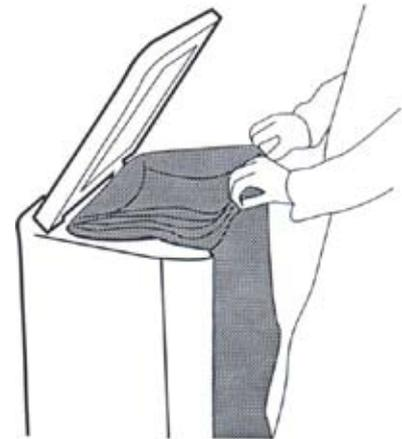
Asegurar el contorno de bolsa en el borde de la pestaña de fijación y devolver la pletina de sujeción a su posición original.
