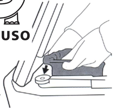
Con la tapa abierta, colocar la bolsa en el interior del contenedor, entre la pletina de sujeción y el fondo.
